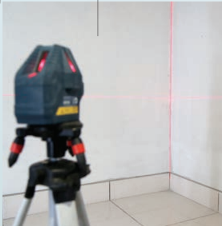
Pengecekan kualitas verticality dinding dengan laserline.
